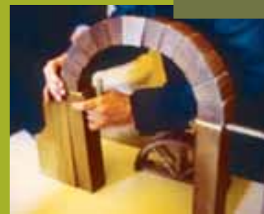
Maquette pédagogique de la construction d'un arc en plein cintre. Ateliers du patrimoine de la Conciergerie, Centre des monuments nationaux.
